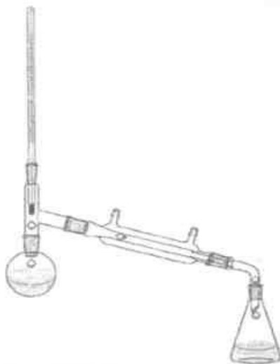
Р и с. 2.1. Простая перегонка
